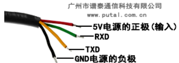
PTC02B-200 TTL 通讯接口定义图
