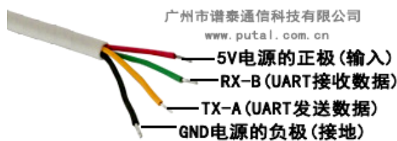
PTC01B-130 TTL通讯接口定义图
